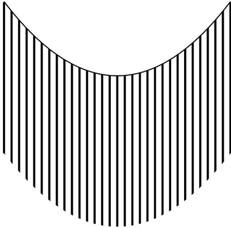
*Abbildung 5: Welche Form nimmt der tragende Faden an, wenn er gleichmässig durch gleich schwere Ketten belastet wird?*
