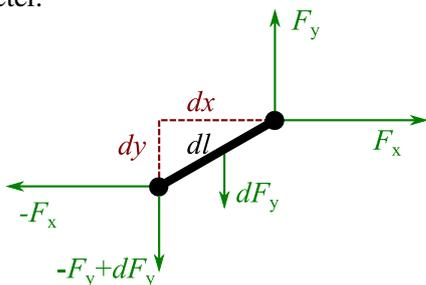
Abbildung 2: Auf ein Kettenglied der Länge  $dl$  wirken die Zugkraft der Kette oberhalb des Glieds (aufgeteilt in  $F_x$  und  $F_y$ ), die Zugkraft der Kette darunter sowie die Gewichtskraft  $dF_y$ . Die Skizze ist nicht massstäblich.
