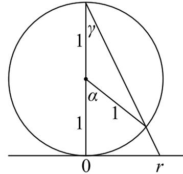
Damit alle Pixel im projizierten Bild erwischt werden, dreht man die Rechnung am besten um: Aus der Pixelnummer (Bild-Koordinate) wird die Blickrichtung, aus der Blickrichtung die Koordinate des Gegenstandspunktes auf dem Poolboden und daraus die Farbe der Kachel berechnet. Entsprechend dieser Farbe wird das Pixel im Bild schwarz oder weiss gemalt.
